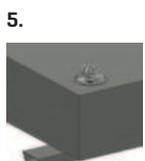
4) Vyrovnejte chrlič do požadované polohy a utáhněte šroub. | Align the gargoyle in the desired position and tighten the screw. | Orientez la gargouille dans la position souhaitée et serrez la vis.
