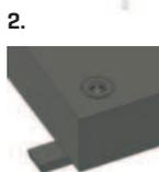
2) Vložte chrlič s trubkou nejprve zespodu přes odtok vody do střechy. | Now insert the gargoyle with the tube first from below through the water drain into the roof. | Introduisez maintenant la gargouille avec le petit tube dans le toit, d'abord par le bas à travers l'écoulement d'eau.
